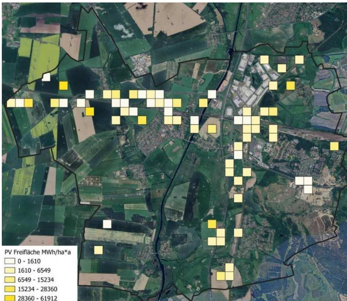
Abbildung 40: Solarpotential durch PV-Anlagen auf Freiflächen (Quelle: FACT)
