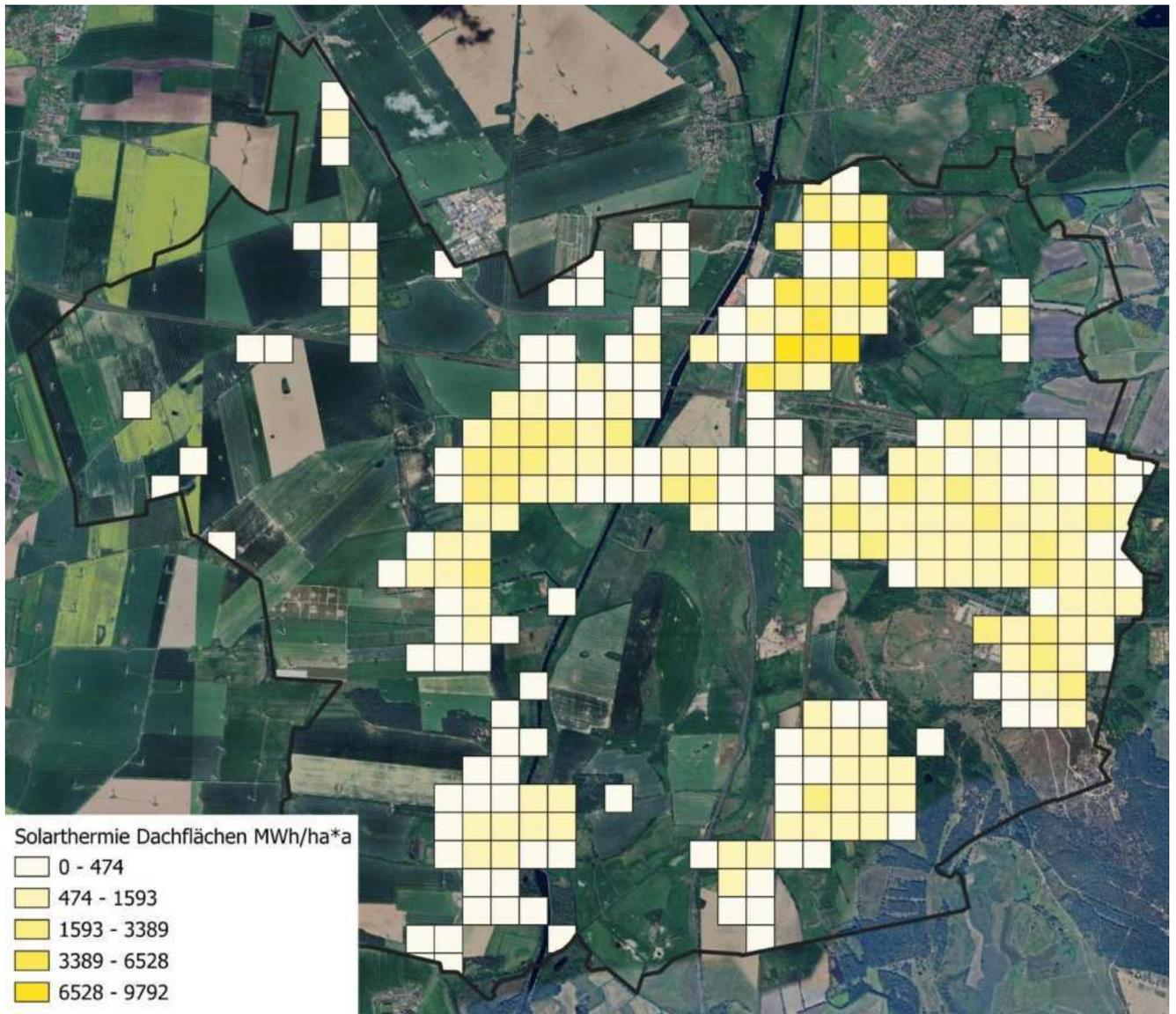
Abbildung 28: Potential Solarthermie Dachflächen (Quelle: FACT)
