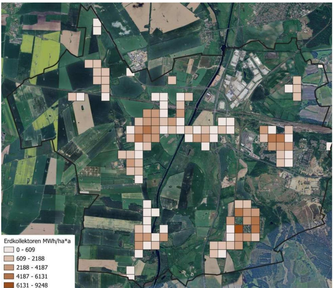
Abbildung 34: Geothermisches Potential von Erdkollektoren in Kombination mit Wärmepumpen (Quelle: FACT)
