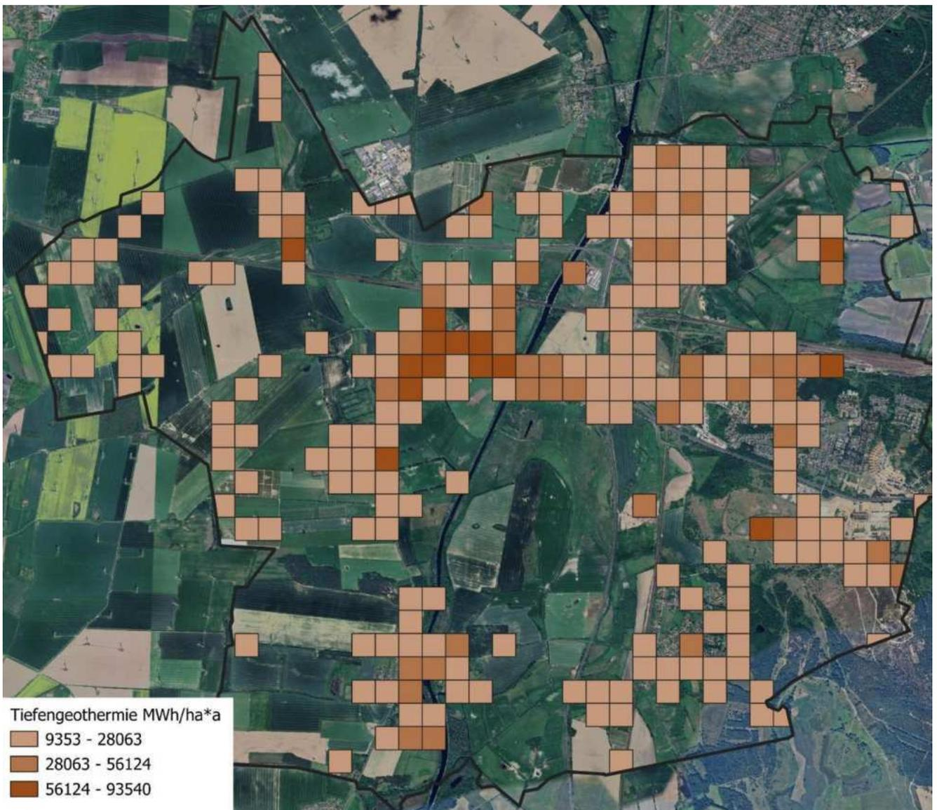
Abbildung 36: Potential der Tiefengeothermie zur regenerativen Wärmebereitstellung (Quelle: FACT)
