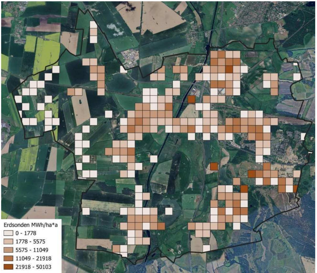
Abbildung 33: Geothermisches Potential durch den Einsatz von Erdsonden in Kombination mit Wärmepumpen
