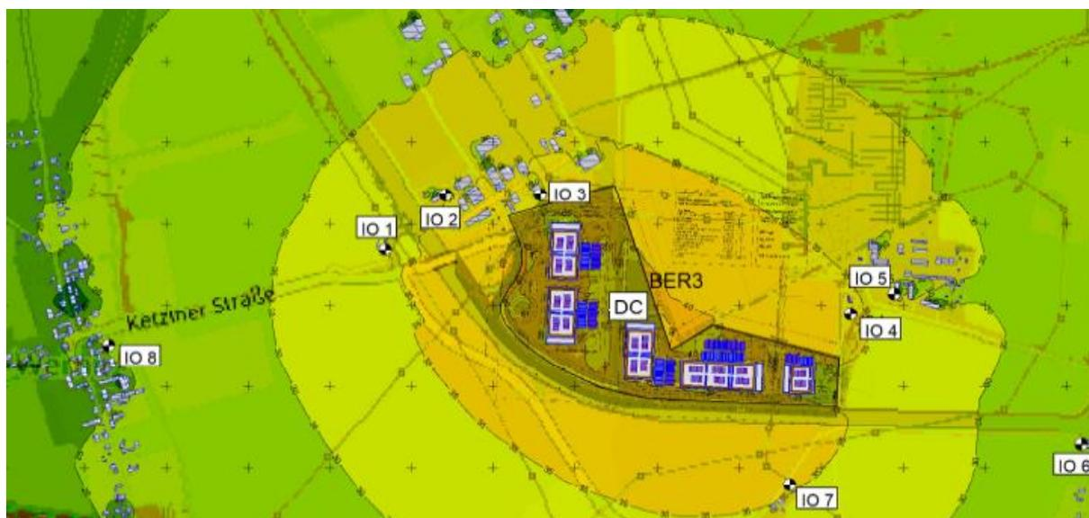
Abbildung 12: Ausschnitt Rasterlärmkarte nachts / Schalltechnische Einschätzung (Quelle: Büro GENEST, 03/2024)
